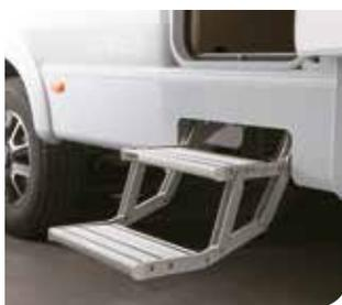
Marchepied électrique pour une montée à bord facilitée (Profilés uniquement).
