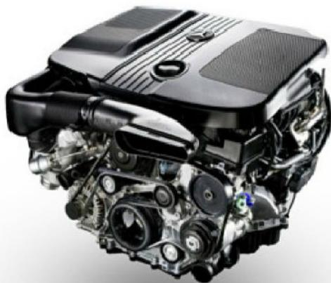
Préparation du mélange : injection directe Common Rail à pilotage électronique, turbocompresseur et interrefroidissement.
