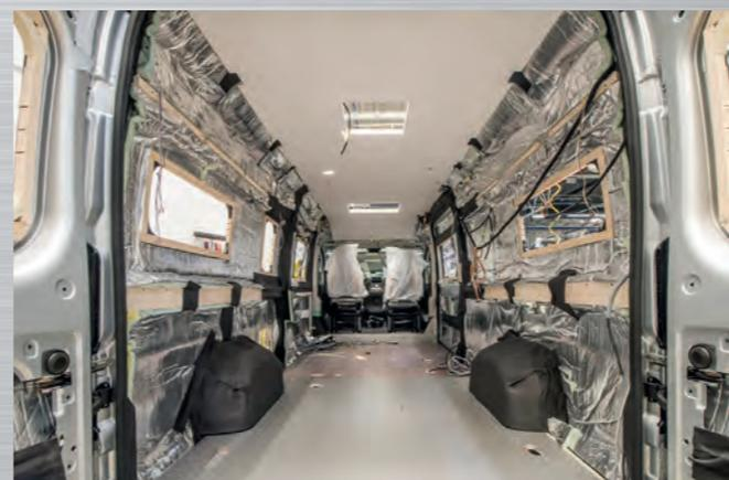
**L'isolation d'un van, c'est capital pour un usage tout au long de l'année.** Pour assurer un meilleur confort en toute saison, Elios pose désormais, dans tous ses véhicules, un film adhésif couplé à un film aluminium ainsi qu'à de la fibre polyéthylène. Il s'agit d'un matériau flexible qui permet d'épouser parfaitement les contours de toutes les carrosseries pour une isolation de haut vol.
