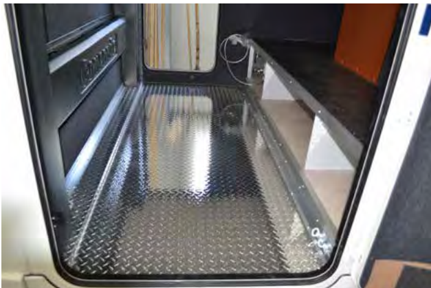
TÔLE STRIÉE EN ALUMINIUM DANS LE GARAGE ARRIÈRE
