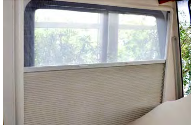
FENÊTRE DE LA CABINE DU CONDUCTEUR AVEC STORE OCCULTANT ET MOUSTIQUAIRE
