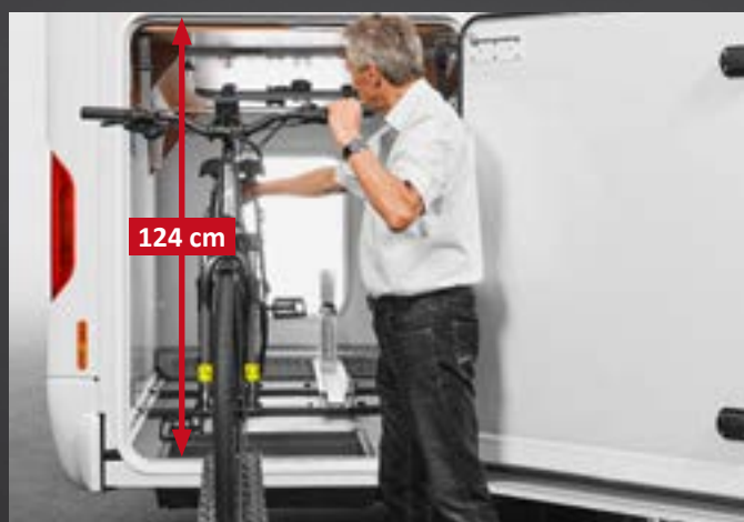
Augmentation de la hauteur de chargement en relevant le lit arrière avec une main et grâce à l'évidement décaissé dans le plancher
