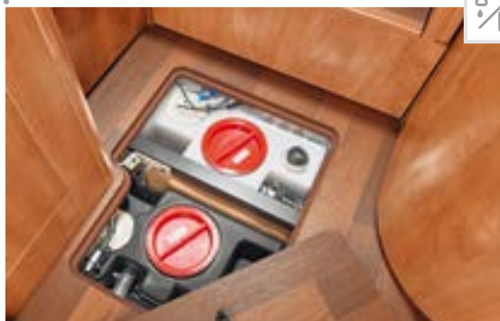
Réservoirs d'eau dans le double plancher chauffé, à l'abri du gel
