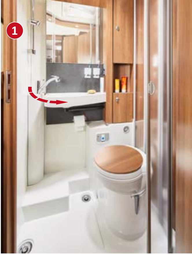
Salle de bains pivotante Vario : cabinet de toilettes et toilettes ❶ ou douche ❷ grâce à la cloison-miroir pivotante avec lavabo (I 141 LE)
