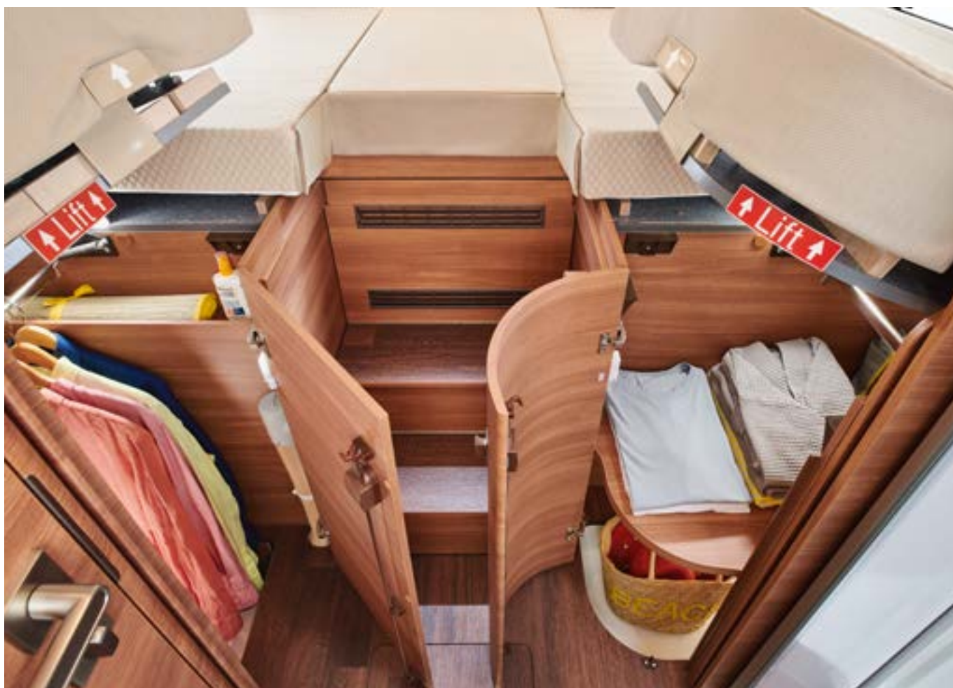
Grandes penderies sous les lits jumeaux longitudinaux, hauteur intérieure max. 124 cm* accessibles par devant et par le haut grâce à la fonction de levage
