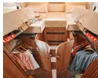
La fonction ascenseur permet d'accéder aisément aux penderies par le haut et par devant
