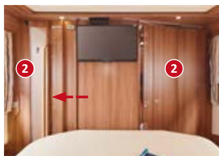
① Position de conduite, ② position médiane pour regarder la télé, ③ position pour dormir avec séparation complète de la pièce. Cloison-TV et cloison de séparation avec porte coulissante sortie et porte pivotante, pour séparer complètement la chambre et le dressing (I 51 QB et I 52 QB)
