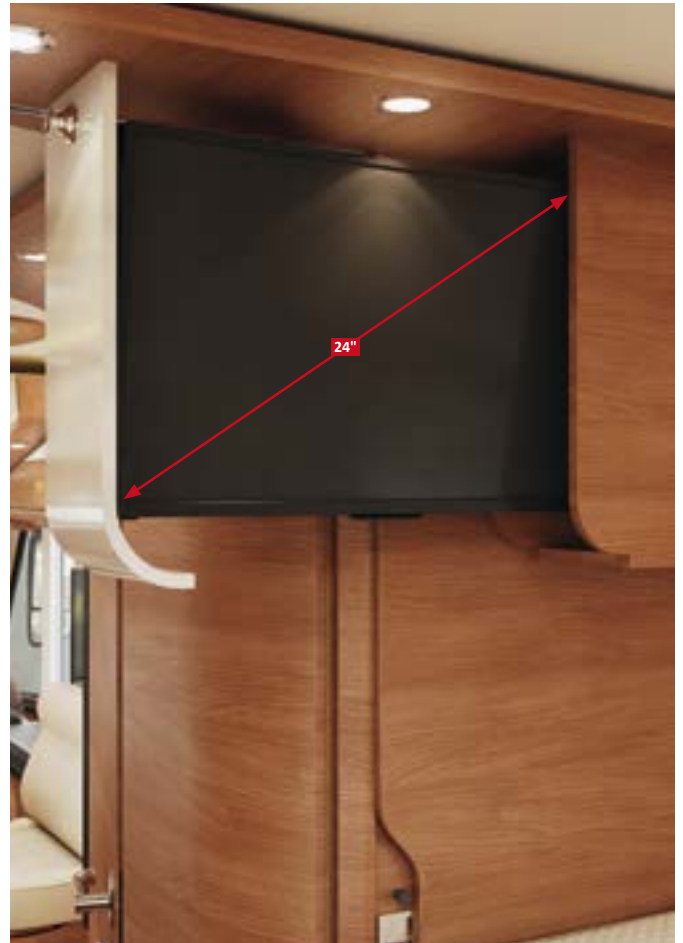
Placard-TV avec système coulissant de la TV spécial, téléviseur LED de 24" incl. sur les modèles avec lits jumeaux longitudinaux (option)
