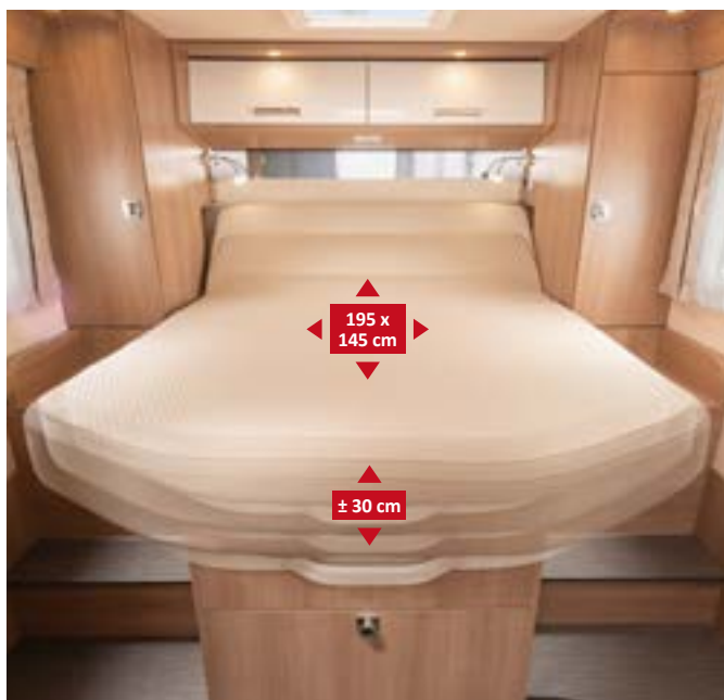
Le couchage peut être déplacé de 30 cm pour être plus à l'aise le jour/la nuit sur les véhicules courts (I 144 QB)
