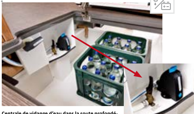
Centrale de vidange d'eau dans la soute profondément décaissée dans le double plancher – celle-ci peut également être commandée par la porte de cellule
