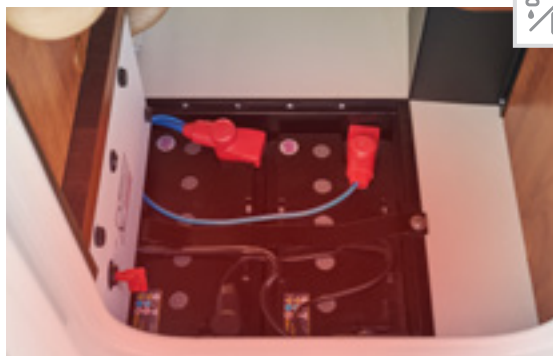
Centrale à batteries chauffée avec interrupteur principal des batteries ; de série : batteries gel 2 x 80 Ah, batterie lithium-ion 90 Ah en option avec contrôleur de batteries
