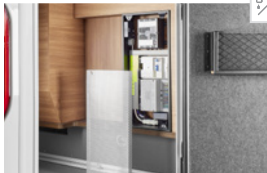
Centrale électrique facilement accessible dans le garage
