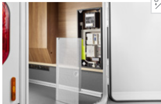
Centrale électrique bien accessible dans le garage
