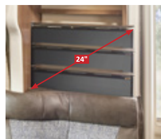
Système coulissant de la TV derrière le dossier de la banquette latérale
