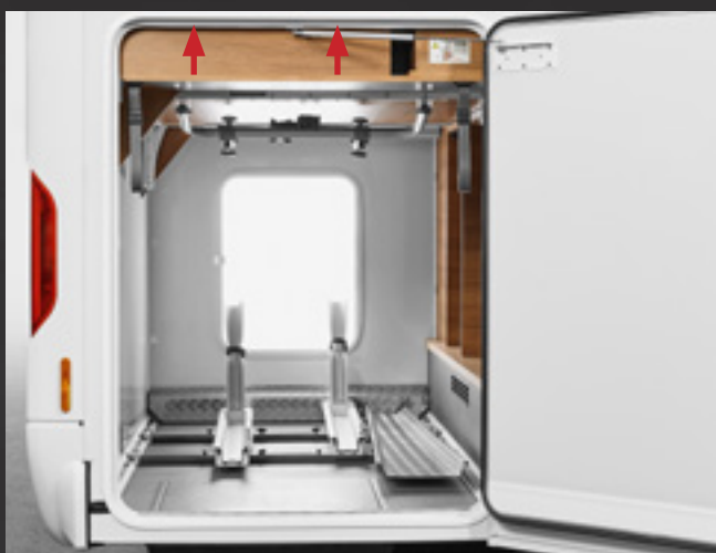
Chargement aisé d'un vélo électrique grâce à la rampe d'accès accrochable
