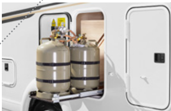
Coffret à bouteilles de gaz (modèle T 143 LE), aisément accessible par le portillon du coffret à bouteilles de gaz séparée. Option : système coulissant pratique pour bouteilles de gaz
