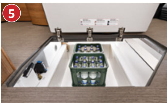
5 Trappe géante dans le plancher de l'habitacle au niveau de l'entrée : aisément chargeable depuis l'extérieur lorsque la porte de cellule est ouverte
