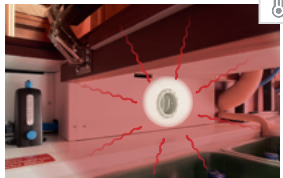
Système de chauffage par accumulateur de chaleur Truma Combi 6 avec des bouches d'air chaud dans l'ensemble du double plancher accumulateur de chaleur, au niveau de l'habitacle, dans le garage, en cabine et au niveau des portes
