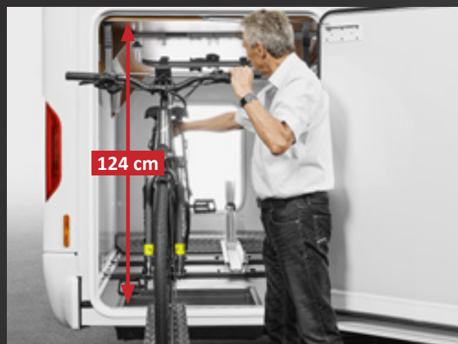
Augmentation de la hauteur de chargement en relevant le lit arrière avec une main. L'évidement qui accueille le vélo est décaissé dans le plancher : une hauteur de guidon de 124 cm est donc possible
