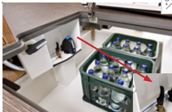
Centrale de vidage d'eau dans la soute profondément décaissée dans le double plancher , peut également être commandée par la porte de cellule
