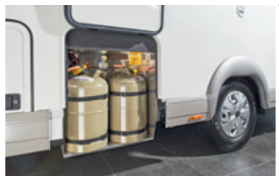
Coffret à bouteilles de gaz « easy change » , profondément décaissé, facilitant le remplacement des bouteilles
