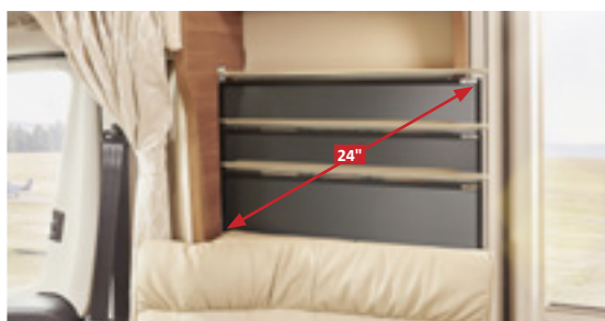
Système coulissant de la TV derrière le dossier
