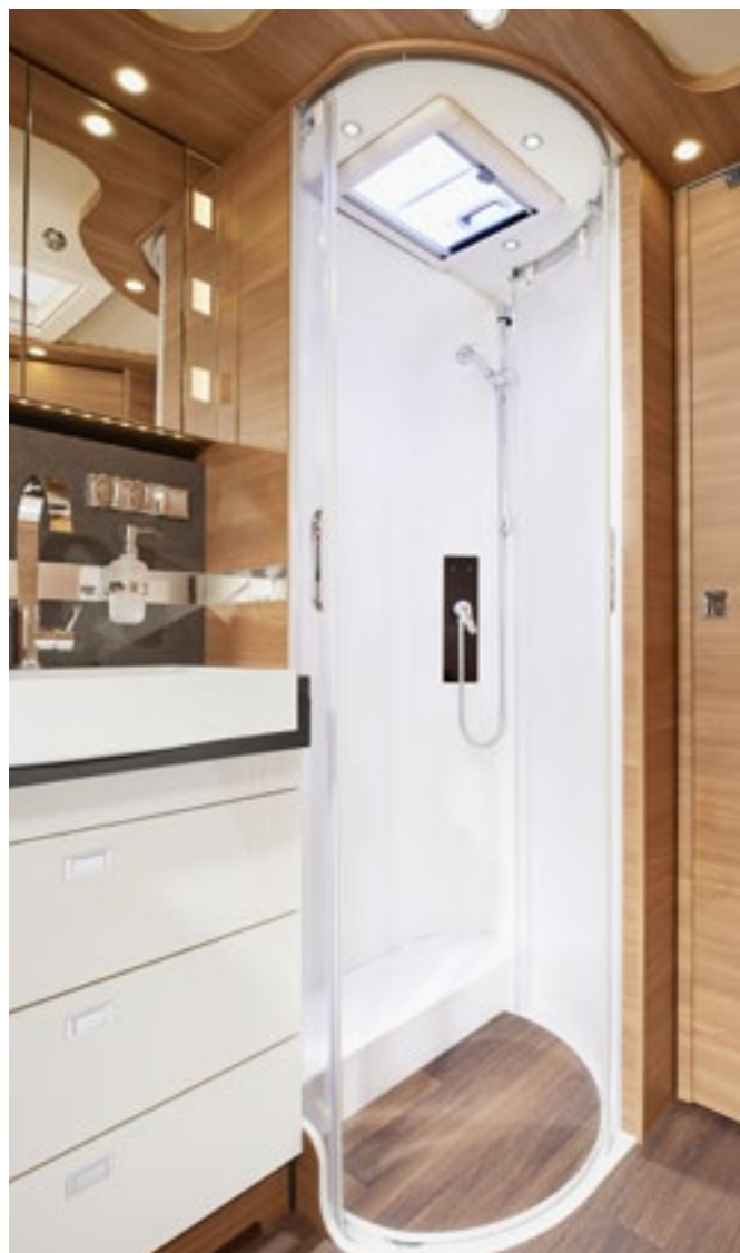
Douche circulaire XL avec caillebotis hydrofuge de même design que le plancher de l'habitacle (aisément amovible pour le nettoyage), lanterneau avec plissé occultant
