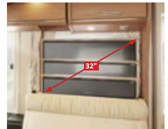
Système coulissant de la TV derrière le dossier du canapé latéral
