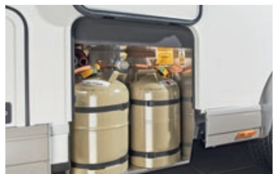
Coffret à bouteilles de gaz « easy change » , profondément décaissé, facilitant le remplacement des bouteilles, les deux bouteilles sont accessibles individuellement (sauf sur les modèles I 138 DB, I 141 LE, I 143 LE)
