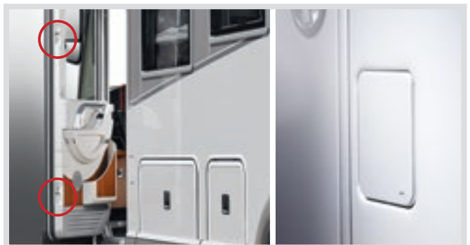
Portière de cabine disposant d'un seuil très bas et d'un double verrouillage de sécurité. Bouchon du réservoir de carburant affleurant dans la paroi latérale
