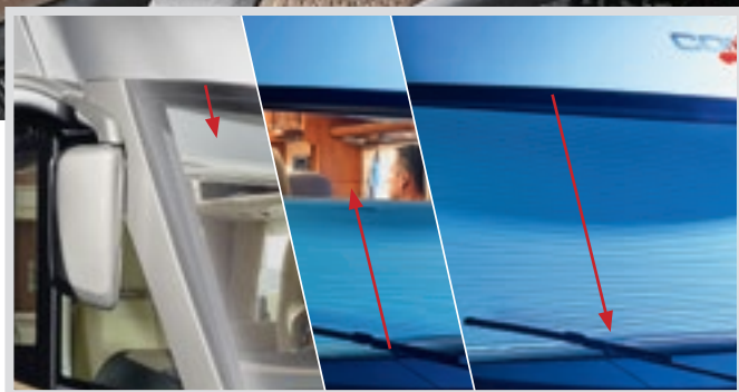
Store de pare-brise plissé isolant multifonctions à commande horizontale : fait office de pare-soleil, de pare-vue et de système occultant isolant. À partir du chic e-line, plissé de pare-brise électrique avec fonction Privacy et pare-soleil de série, programmable individuellement
