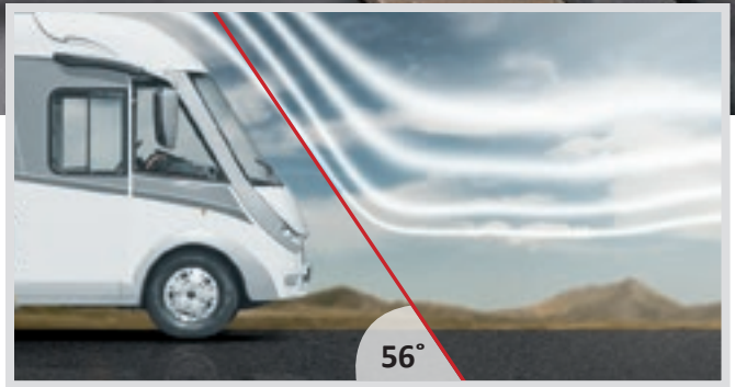
Face avant de forme tridimensionnelle, angle d'inclinaison plat = moins de résistance d'air, donc consommation de carburant moindre et moins de bruits dus aux vents
