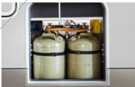
Coffret à gaz « easy change » , profondément décaissé, avec portillon manipulable à une main, permettant un remplacement aisé des bouteilles accessibles individuellement
