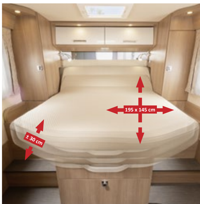
Un brevet a été déposé pour le couchage qui peut être déplacé de 30 cm pour être plus à l'aise le jour/la nuit sur les véhicules courts (I 144 QB)
