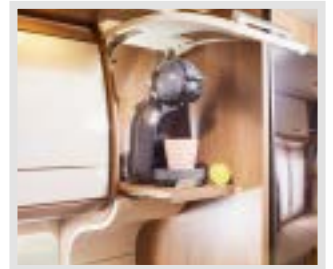
▲ Système coulissant de la cafetière à capsules dans le placard de pavillon au-dessus de la cuisine
