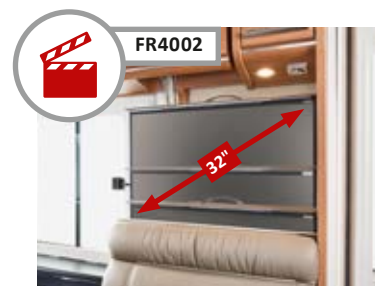
▲ Système coulissant de la TV derrière le dossier de la banquette latérale
