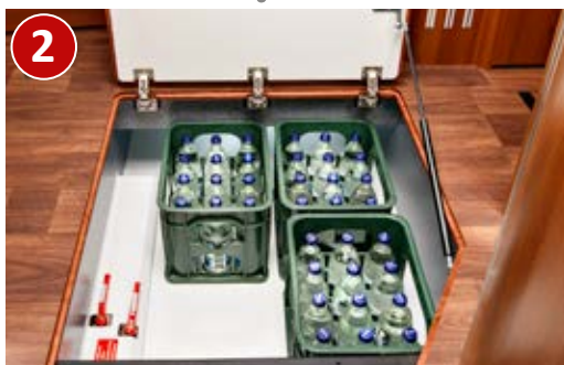
▲ Trappe géante dans le plancher au niveau de l'entrée : aisément chargeable depuis l'extérieur lorsque la porte de cellule est ouverte.
