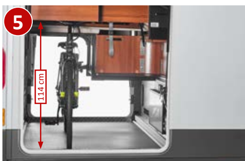
▲ Garage liner-for-two I 53 avec augmentation de la hauteur pour le guidon sur châssis Iveco 50C
