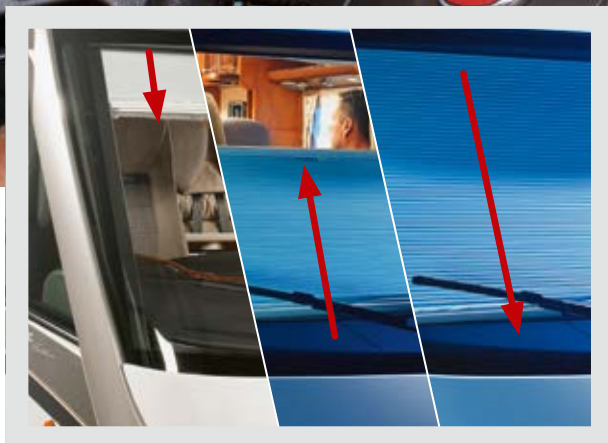
▲ Store de pare-brise plissé isolant multifonctions à commande horizontale : fait office de pare-soleil, de pare-vue et de système occultant isolant
