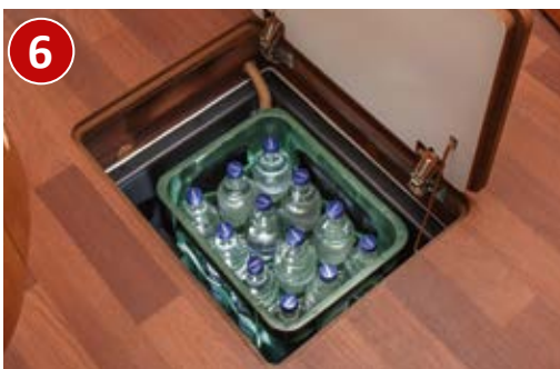
▲ Grande trappe relevable dans le plancher de l'habitacle caisse de rangement (prof. utile 42 cm), dans le double plancher chauffé
