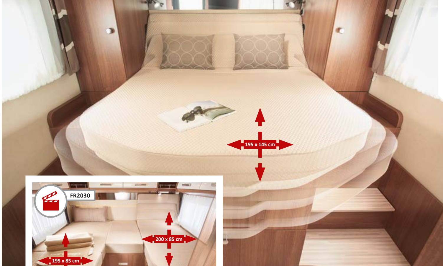
▲ Un brevet a été déposé : le couchage peut être déplacé de 30 cm pour avoir plus d'espace disponible le jour/la nuit sur les véhicules courts (I 144 QB)
