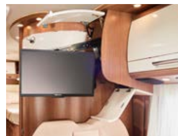
▲ Système coulissant de la TV dans le rangement de pavillon au-dessus du salon
