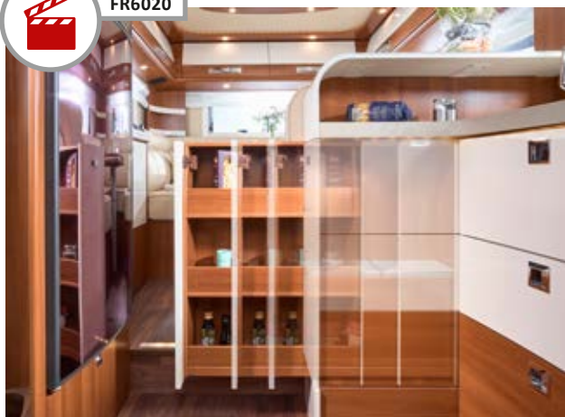
▲ Bar de cuisine surélevé avec grand placard à provisions et porte coulissante s'ouvrant dans le sens opposé, surface = extension du plan de travail
