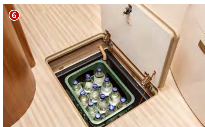
Trappe dans le plancher au-dessus de la caisse de rangement dans le double plancher, hauteur : 40 cm
