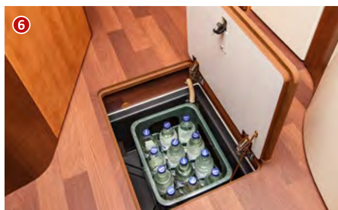
Trappe dans le plancher au-dessus de la caisse de rangement dans le double plancher, hauteur : 40 cm
