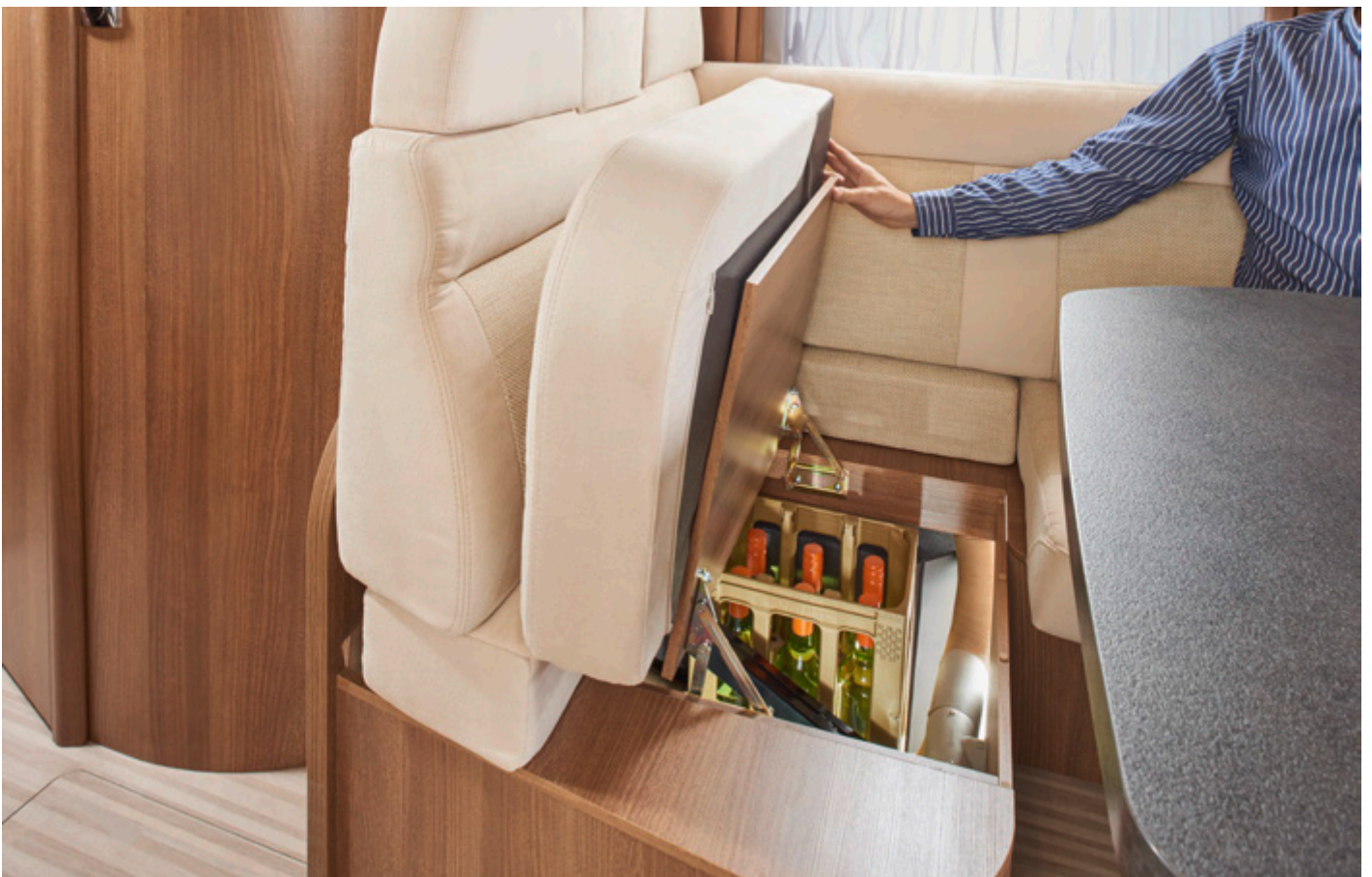
Couvercle de la banquette à charnières patentées pour un accès facile au double plancher (sans enlèvement des coussins)
