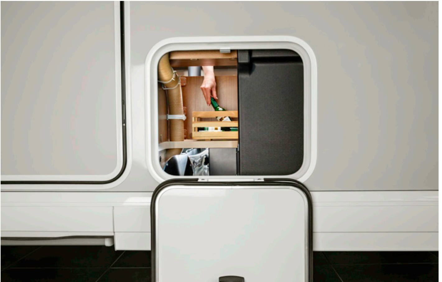
Rangement „easy entry“ dans le double plancher chauffé avec deux portes de soutes (côté conducteur /passager) et rangement à travers central (charger de l'extérieur et décharger depuis l'intérieur)
