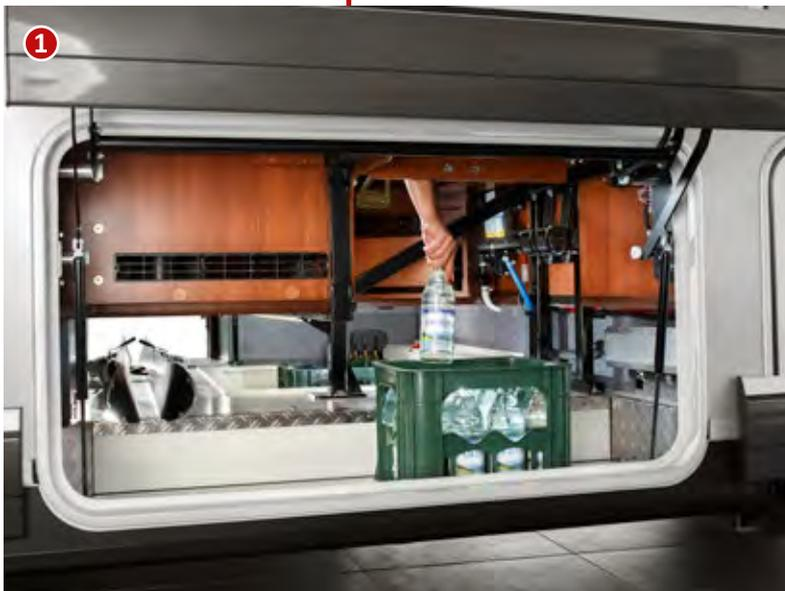
Porte de soute de type bus avec mécanisme d'ouverture à parallélogramme
