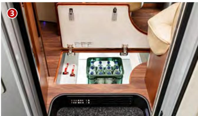
Trappe géante dans le plancher derrière la porte de cellule au-dessus de la soute profondément décaissée dans le double plancher
