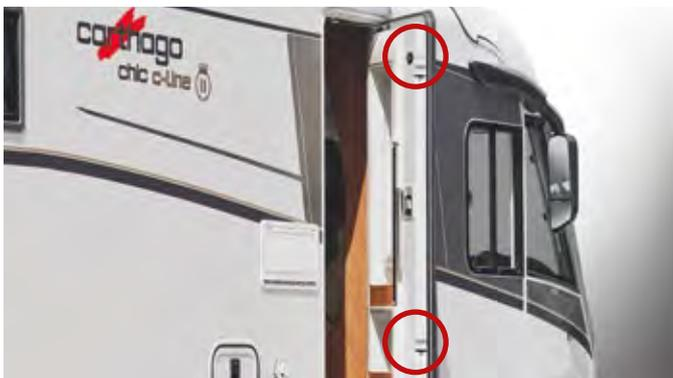
avec double verrouillage de sécurité, limiteur d'ouverture, vitre et store moustiquaire
