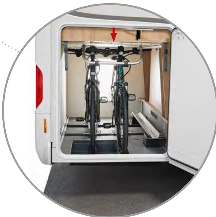
Le système coulissant / de transport et de fixation permet de glisser le vélo électrique à l'intérieur du garage et de le fixer en un tour de main et de manière fiable pour la route
