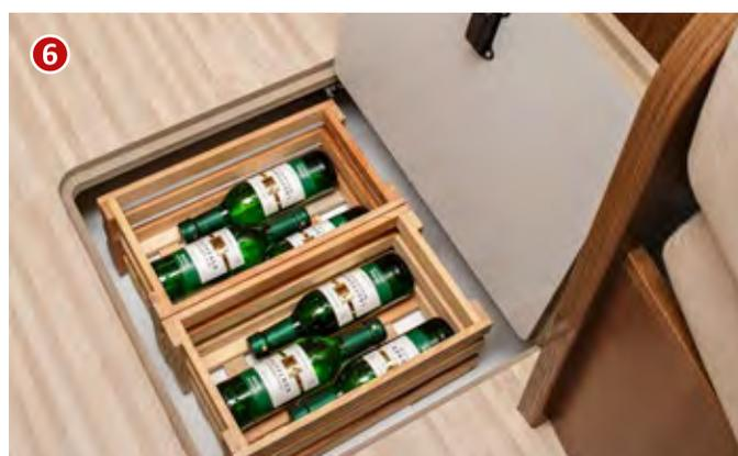
Trappe dans le plancher au-dessus de la caisse de rangement dans le double plancher
