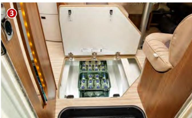
Trappe géante dans le plancher derrière la porte de cellule au-dessus de la soute profondément décaissée dans le double plancher
