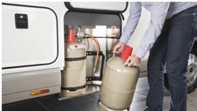
Coffret à bouteilles de gaz
