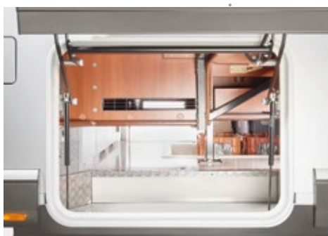
Rangement « jumbo space » décaissé sur les côtés, accès depuis l'extérieur par les grandes portes de soutes à système de fermeture à parallélogramme, accessible depuis l'intérieur par la banquette latérale et les canapés. Rangement à travers central, éclairé.
