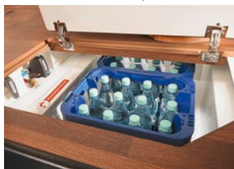
Rangement profondément décaissé dans le double plancher , accès depuis l'intérieur par la trappe dans le plancher, centrale d'évacuation d'eau intégrée.
