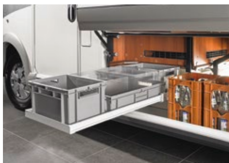
Caisses de rangement dans le double plancher Système coulissant avec caisses emboîtables amovibles
