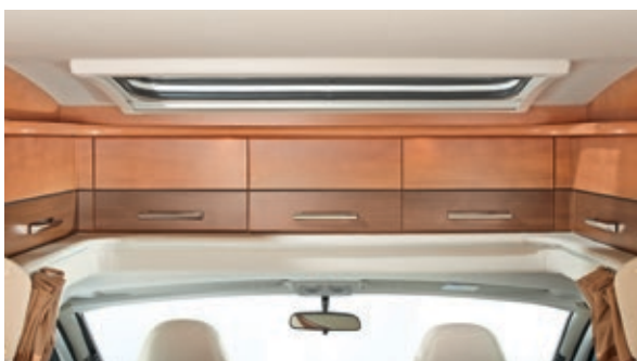
Placards de pavillon périphériques en cabine
