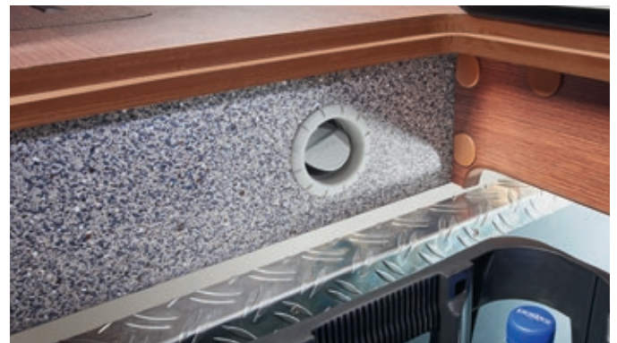
Bouches d'air chaud dans le double plancher
