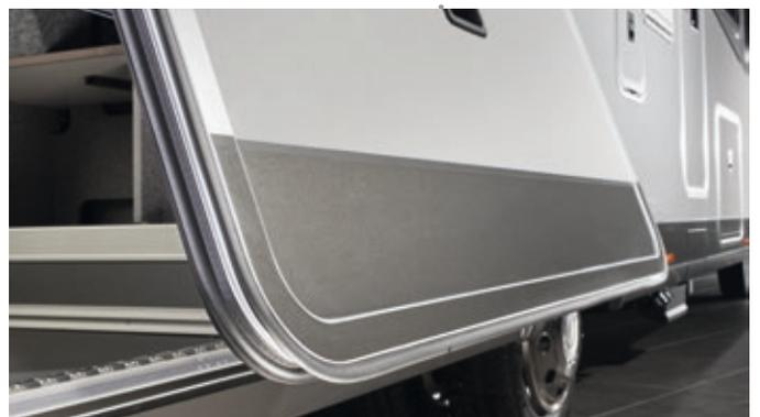
Garage avec portillons à vérins pneumatiques des deux côtés, double système d'étanchéité, joint extérieur comme protection contre les projections d'eau, charnières de porte noyées invisibles
