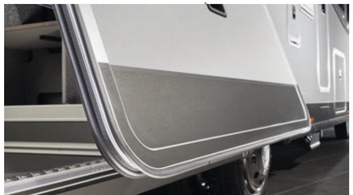
Portillons du garage avec vérins pneumatiques des deux côtés, double système d'étanchéité, joint extérieur comme protection contre les projections d'eau, charnières de porte noyées invisibles
