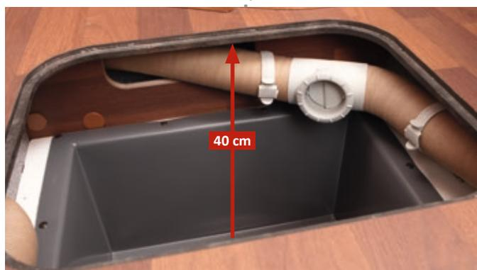
Boîtes de rangement décaissées dans le double plancher : profondeur utile 40 cm, accès depuis l'intérieur par la trappe dans le plancher (selon le modèle)
