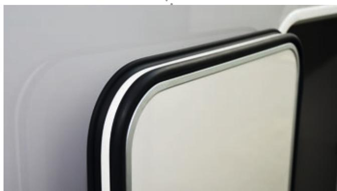
Porte extérieure avec double système d'étanchéité, joint extérieur comme protection contre les projections d'eau
