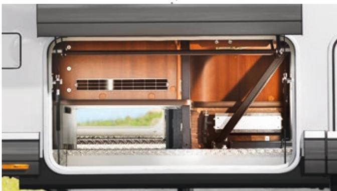
Grandes trappes de soute avec mécanisme d'ouverture à parallélogramme, assurant un accès aisé aux rangements décaissés sur les côtés dans le double plancher et au rangement sous les canapés (chargement depuis l'extérieur et accessible depuis l'intérieur); rangement au travers au milieu
