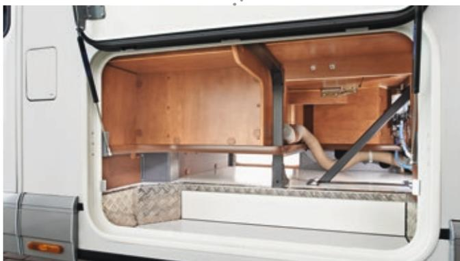
Très grande porte de soute donnant accès aux rangements décaissés dans le double plancher et aux rangements sous les canapés (chargement depuis l'extérieur et accessible depuis l'intérieur); rangement central au travers dans le double plancher
