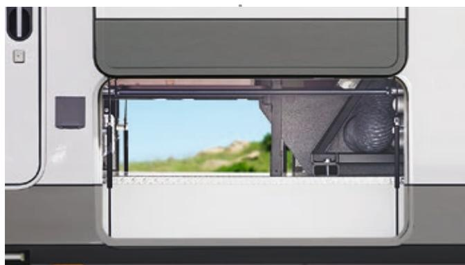
Rangements dans le double plancher, avec accès depuis l'intérieur au moyen de trappes dans le plancher
