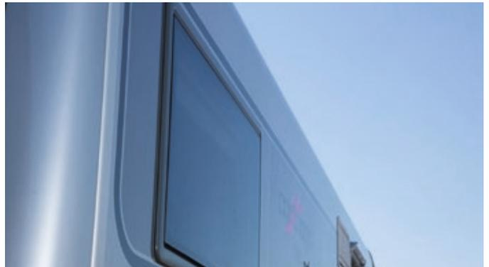
Vitrage isolant avec cadre en PU sans ponts thermiques, vitre extérieure plane
