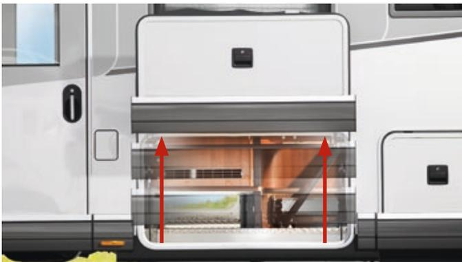
Porte de soute très grande avec mécanisme d'ouverture à parallélogramme - technique innovante
