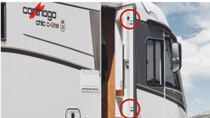
avec double verrouillage de sécurité, limiteur d'ouverture, vitre et store moustiquaire
