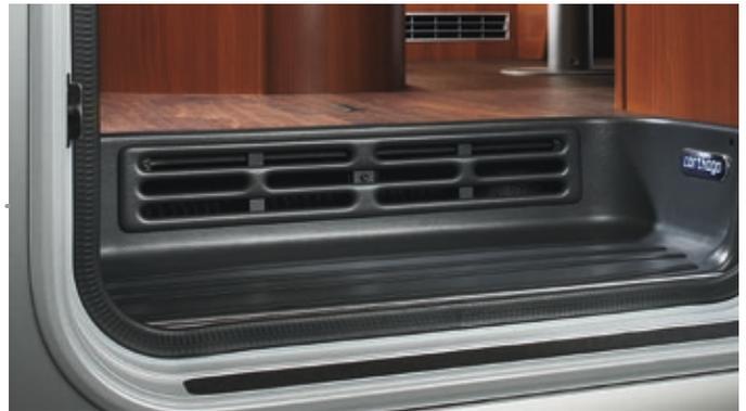
Radiateurs dans le double plancher
