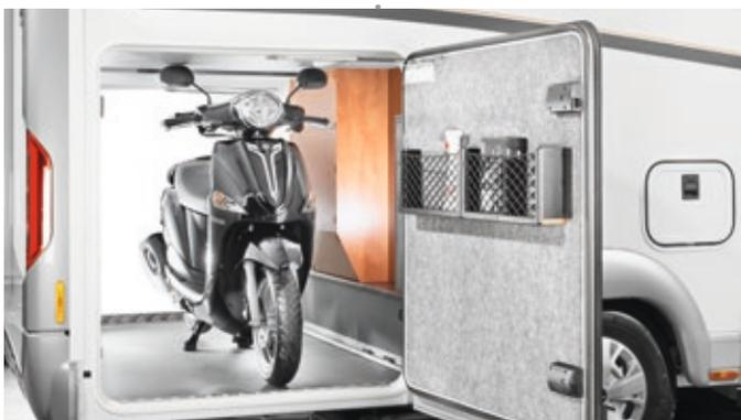
Garage à scooter décaissé profond avec une grande hauteur intérieure, deux grandes portes de garage, rails d'arrimage pour les bagages
