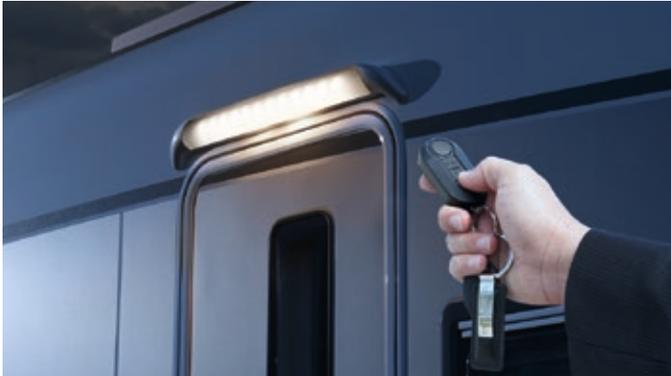
Le verrouillage central au moyen de la télécommande de l'émetteur portable, active simultanément l'éclairage extérieur
