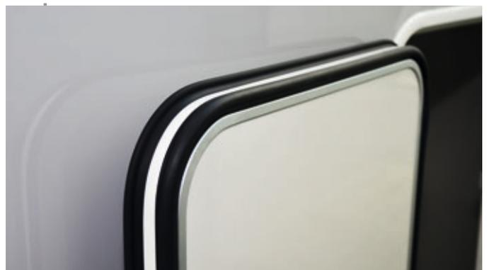
Porte extérieure avec double système d'étanchéité, joint extérieur comme protection contre les projections d'eau, charnières de porte noyées, invisibles
