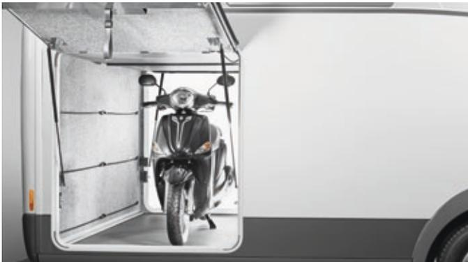
Accès aisé par deux grandes portes de soutes côté conducteur et côté passager, retenues par deux vérins à gaz
