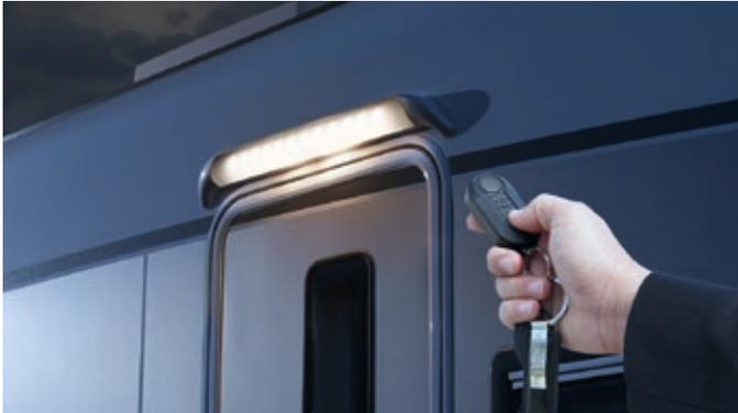
La télécommande dans la clé principale active le verrouillage central et fait office d'éclairage extérieur
