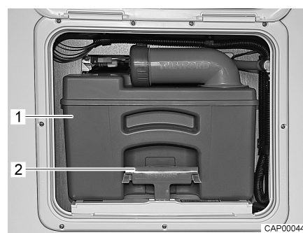
Fig. 99 Réservoir pour matières fécales
