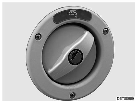
Fig. 79 Couvercle de fermeture pour bec de remplissage d'eau potable
