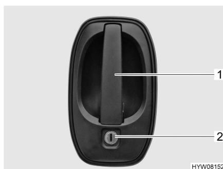
Fig. 6 Serrure de la porte cellule, à l'extérieur
