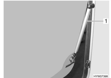
Fig. 11 Fenêtre projetante avec bras automatiques
