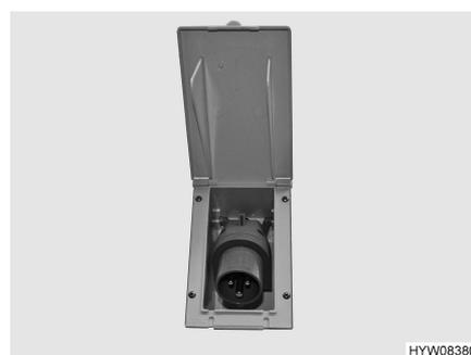
Fig. 57 Raccordement 230 V sur le véhicule
