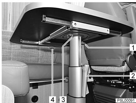
Fig. 30 Décaler/pivoter la table à hauteur réglable
