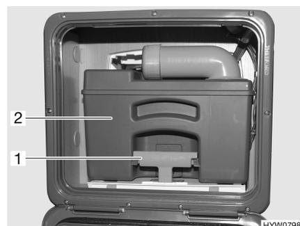
Fig. 95 Réservoir pour matières fécales (alternative)
