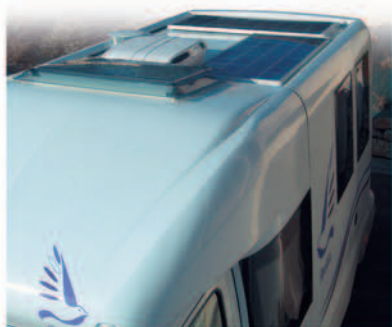
260 W offerts par les panneaux solaires qui alimentent deux batteries auxiliaires.
