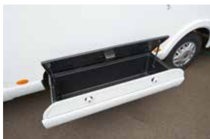
TIROIR BAS DE CAISSE SUR CERTAINS VÉHICULES AVEC DOUBLE PLANCHER SERVICE
