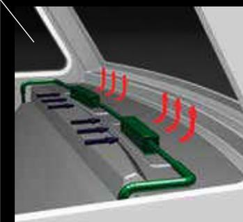
Chauffage au niveau du tableau de bord
