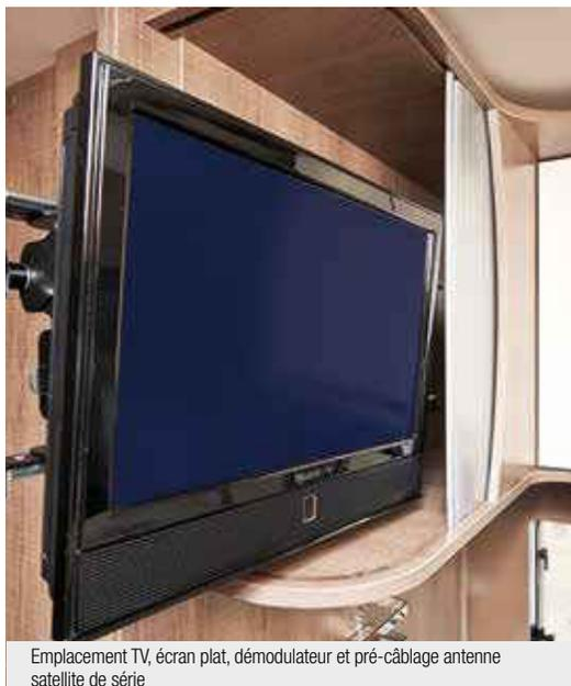
Emplacement TV, écran plat, démodulateur et pré-câblage antenne satellite de série
