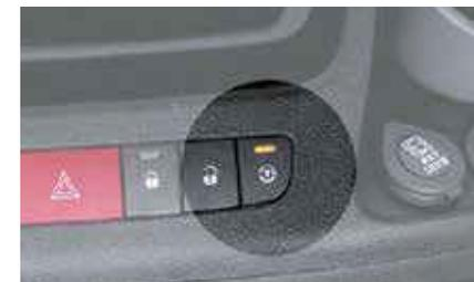
Traction+ (système de contrôle de la traction)
