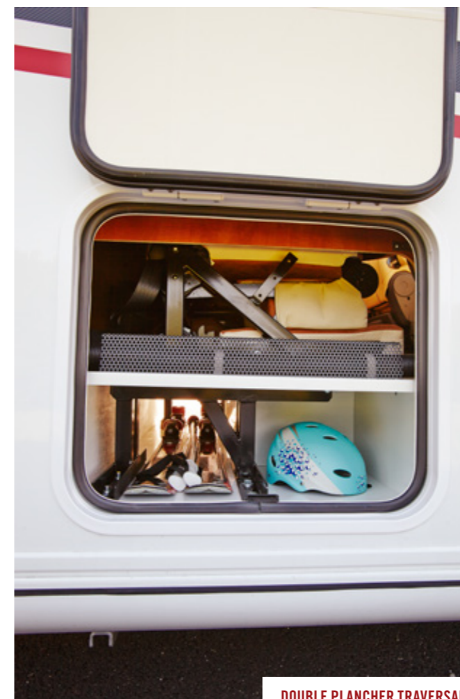
DOUBLE PLANCHER TRAVERSANT
