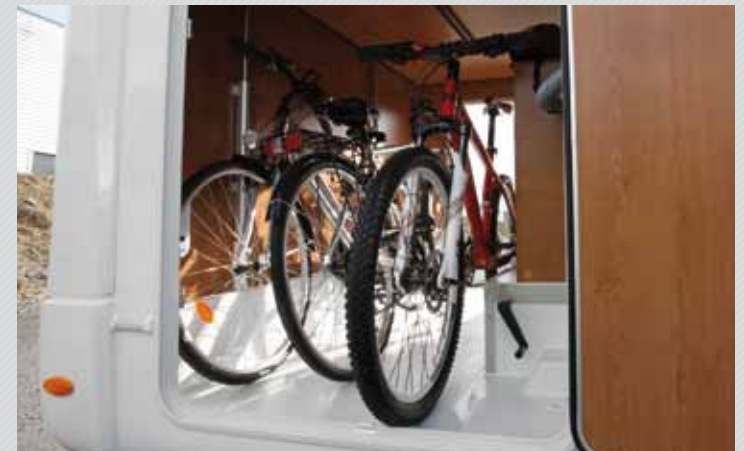
Soute en polyester moulé avec isolation polyuréthane et bondes d'évacuation pour le nettoyage
