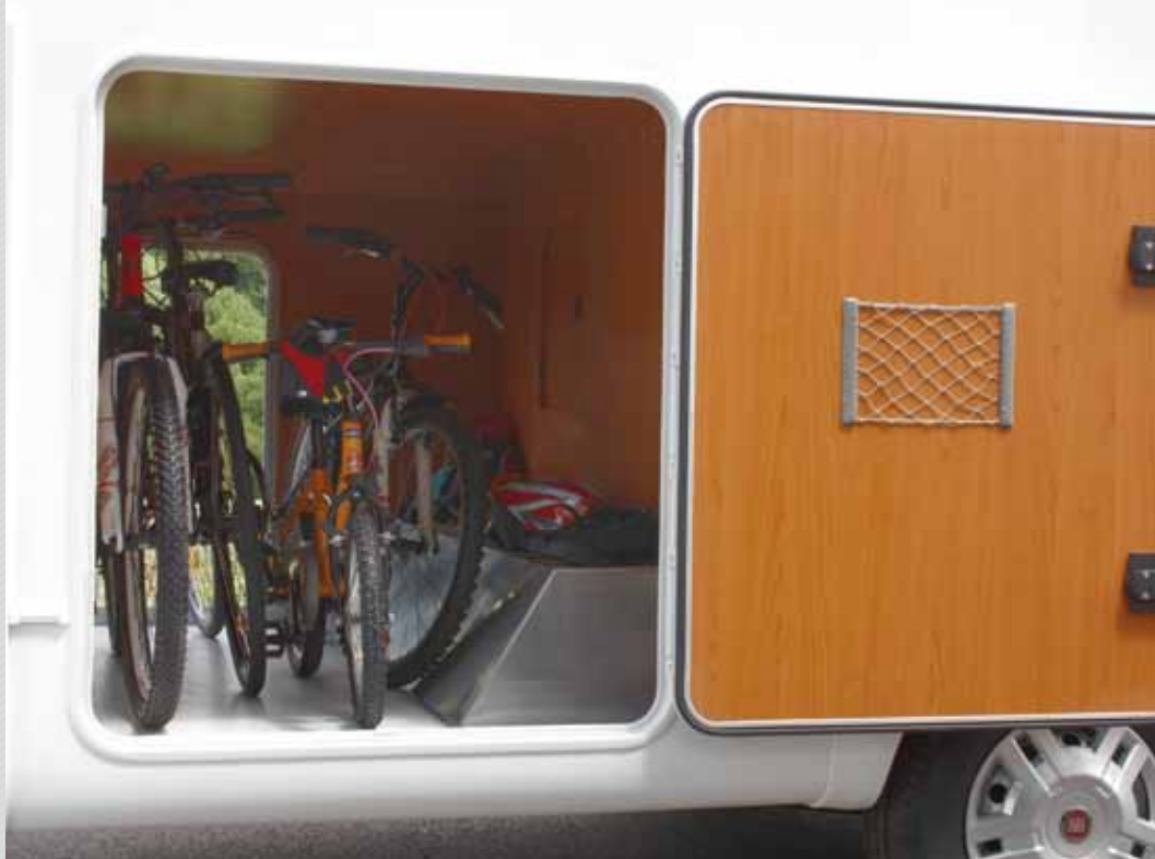
Soute en polyester moulé avec isolation polyuréthane et bondes d'évacuation pour le nettoyage
