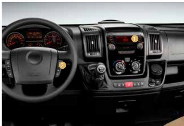
1 Radio DAB Double DIN avec navigation adaptée en option
